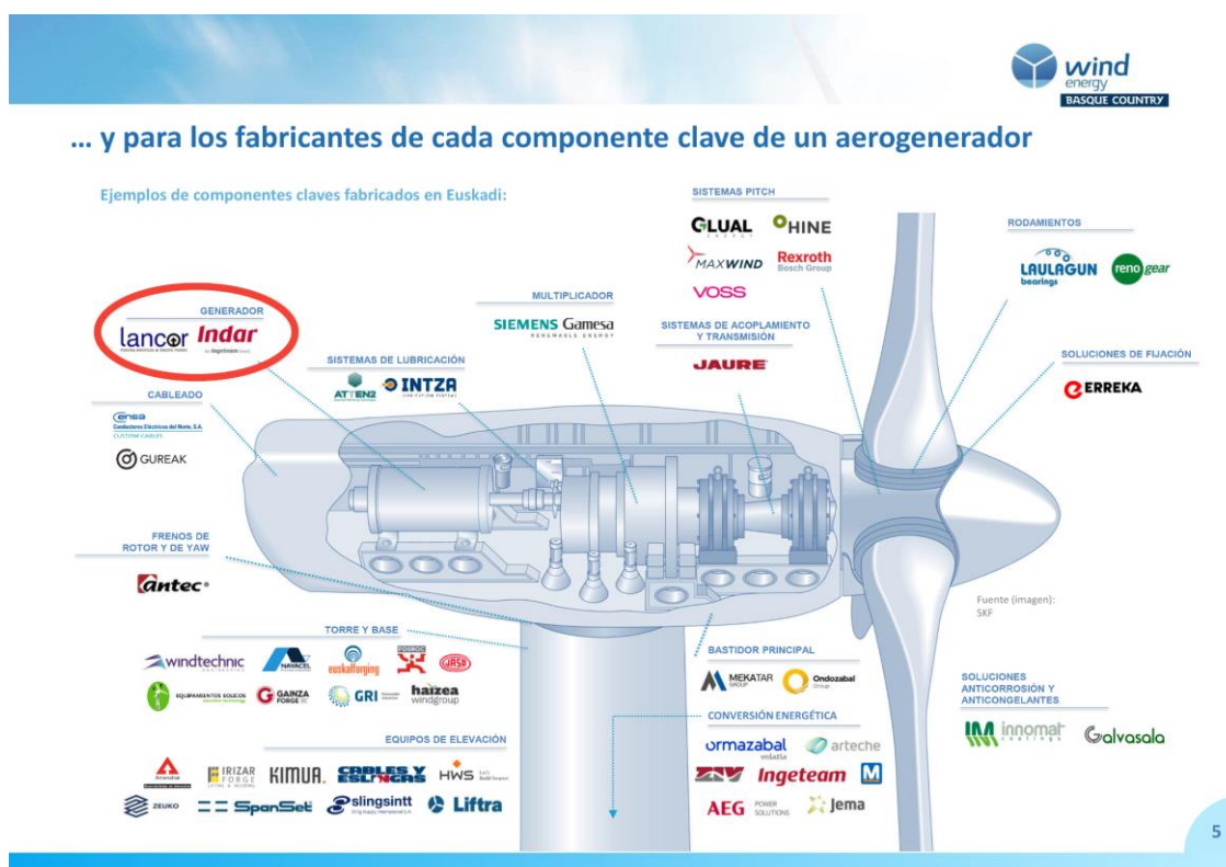
Figura 29: Cadena de valor de la energía eólica en la CAPV. Extraído de Cluster de Energía, 2023 256 .
